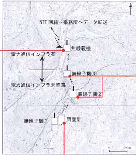
見通しが悪い条件での無線子機設置状況 (相手無線子機は山陰により確認できない)
