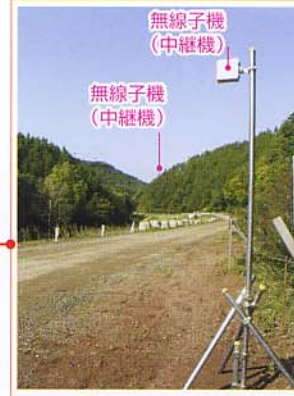
見通しが悪い条件での無線子機設置状況 (相手無線子機は山陰により確認できない)
